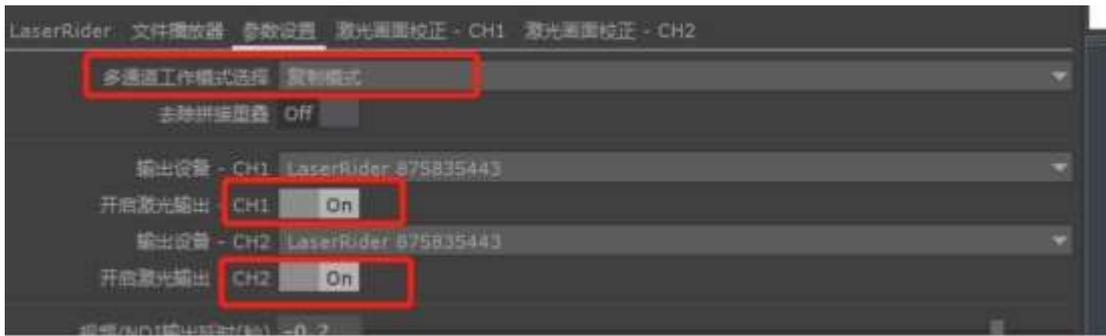
左右拼接模式，拼接完成后，打开去除拼接重叠的开关。可去掉中间的拼接线。拼接线在拼接的时候可以辅助拼接，不建议拼接前就直接关闭。
